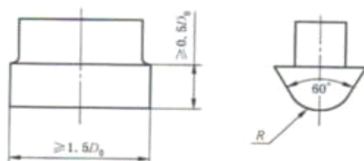
图 G.2 压头的形状尺寸
